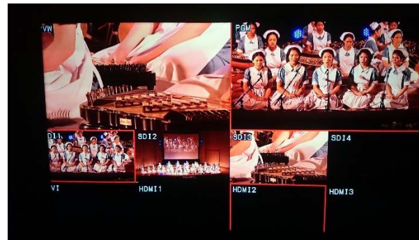
หน้าจอของเครื่องสลับสัญญาณภาพในการบันทึกวีดิทัศน์ และนำสัญญาณภาพไปเผยแพร่ผ่านระบบเครือข่าย
